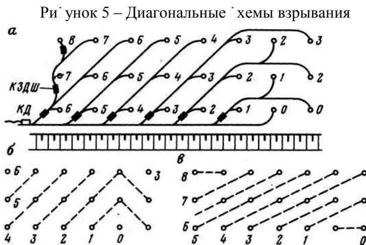
При проведении траншей лучшее дробление обеспечивают врубные схемы монтажа взрывной сети: взрывом одной скважины в первом ряду образуеться вруб, на который и происходит взрывание остальных скважин (рисунок 6).
