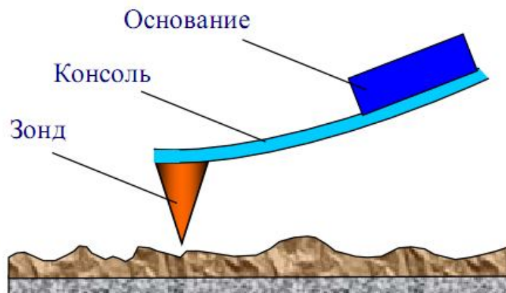
Рис. 60. Схематическое изображение зондового датчика АСМ
