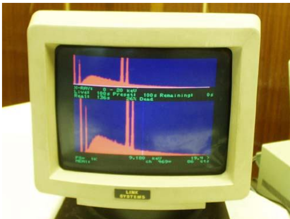
4. Монитор рентгеноспектрального микроанализатора с изображением характеристического рентгеновского спектра.
