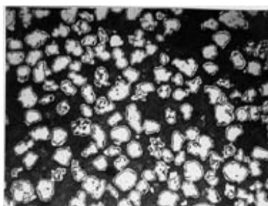
WC планкированный никелем, x200
