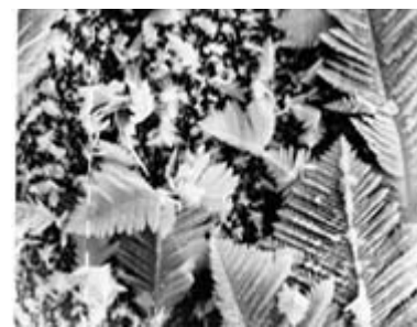
Дендрит Zn, полученный электрохимическим осаждением
