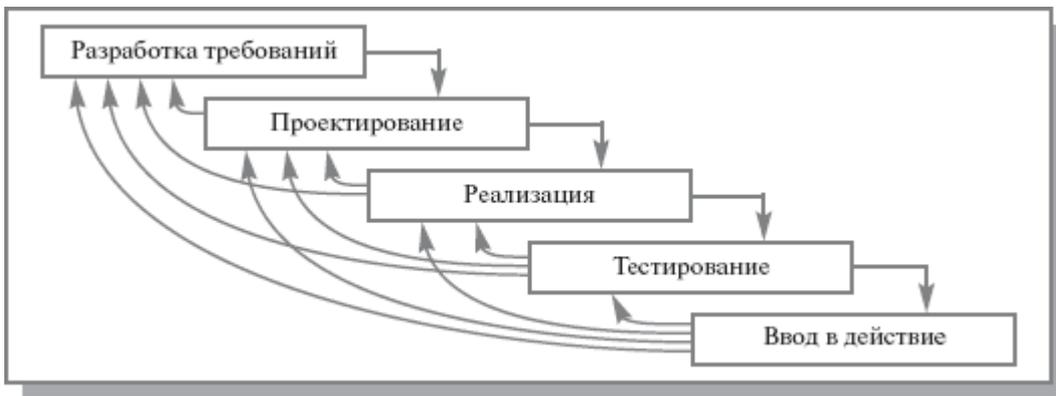
Рис. 2.2. Поэтапная модель с промежуточным контролем
