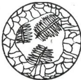
Рис. 1.4. Схема кристаллизации хлористого аммония
