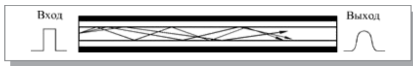
Рис. 6. Распространение света в многомодовом кабеле
