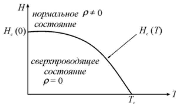
Рис. 5.15. Схематическая фазовая диаграмма, иллюстрирующая нормальное и сверхпроводящее состояние сверхпроводника
