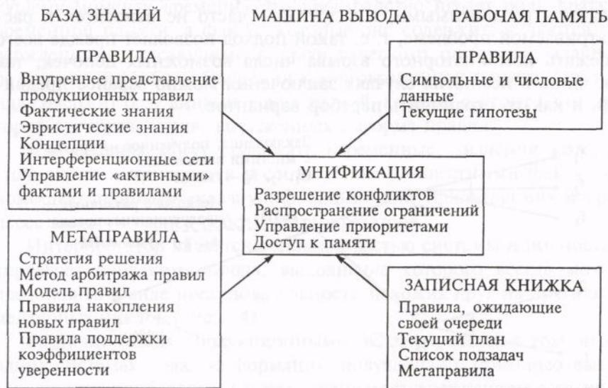
Рисунок 8.2 - Общая схема современной продукционной ЭС
