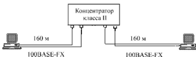
Рисунок 7. Сеть Fast Ethernet максимальной длины
