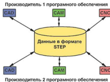
Рис. 2 CALS-технология на основе ISO 10303 STEP
