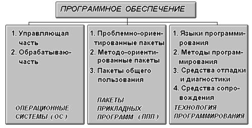
**Операционная система** предназначена для организации вычислительного процесса на ЭВМ, при этом ее **обрабатывающая часть** реализует задачи трансляции, редактирования и сборки, а **управляющая часть** - решение. К основным типам операционных систем, используемых в различных классах ЭВМ, можно отнести - *MS DOS*, *WINDOWS*, *UNIX*, *OS2* и ряд других.
