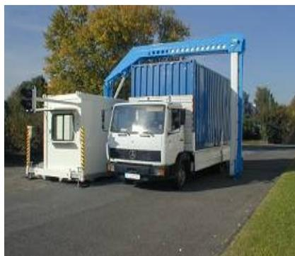
**Рис. 7.11.** Современные инспекционно-досмотровые комплексы на базе рентгеновского излучения
