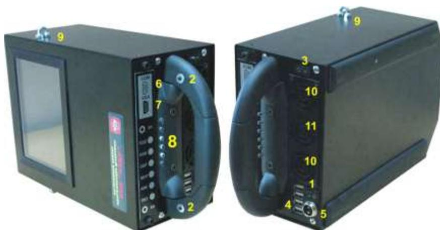
**Рис. 8.21.** Органы управления, коммутации и индикации ППИ «Кедр»
