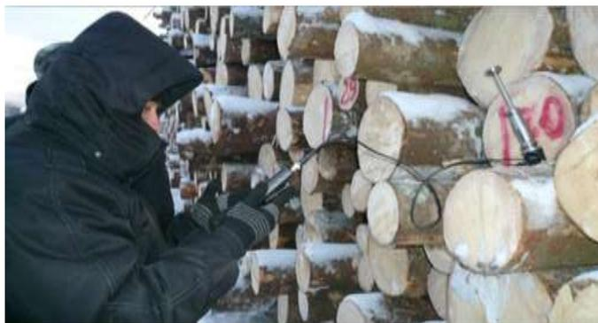
**Рис. 8.24.** Измерение влажности лесоматериалов универсальным влагомером ГМН-3850
