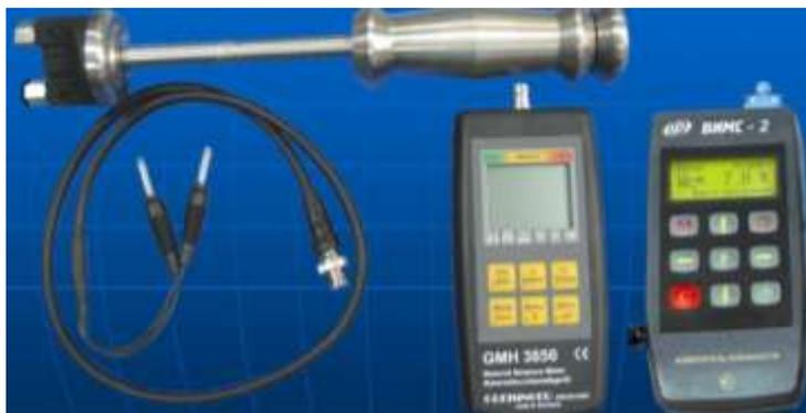
**Рис.8.23.** Измерители влажности ГМН-3850 и ВИМС-2
