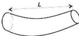
Рис. 7.3. Измерение длины бревна с кривизной
