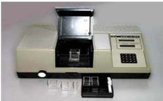
**Рис. 3.6.** Фотоэлектроколориметр лабораторный КФК-3-01.
