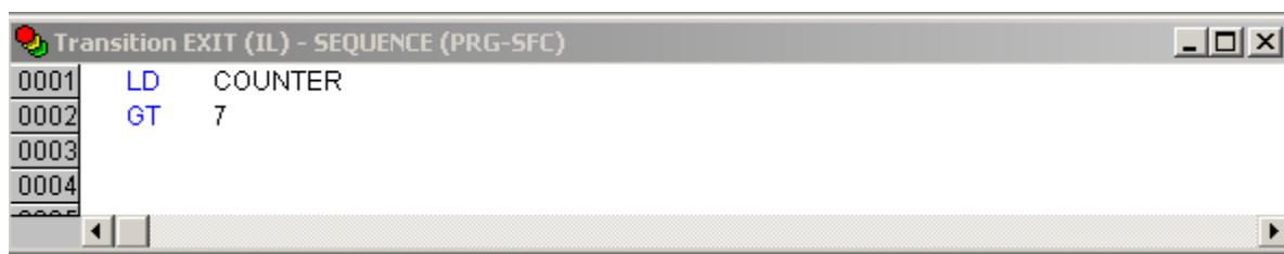
Рис. 14. Программирование перехода EXIT
