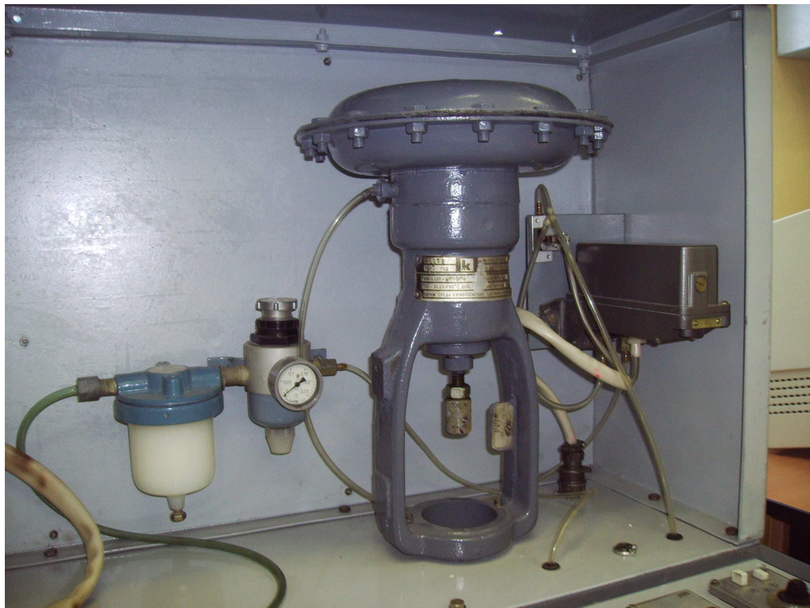
Рис. 8. Система подготовки воздуха и управления диафрагменным исполнительным механизмом
