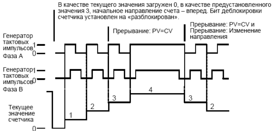
Рис. 7. Пример работы в режимах 9, 10 или 11 (квадратурный режим, однократная скорость)
