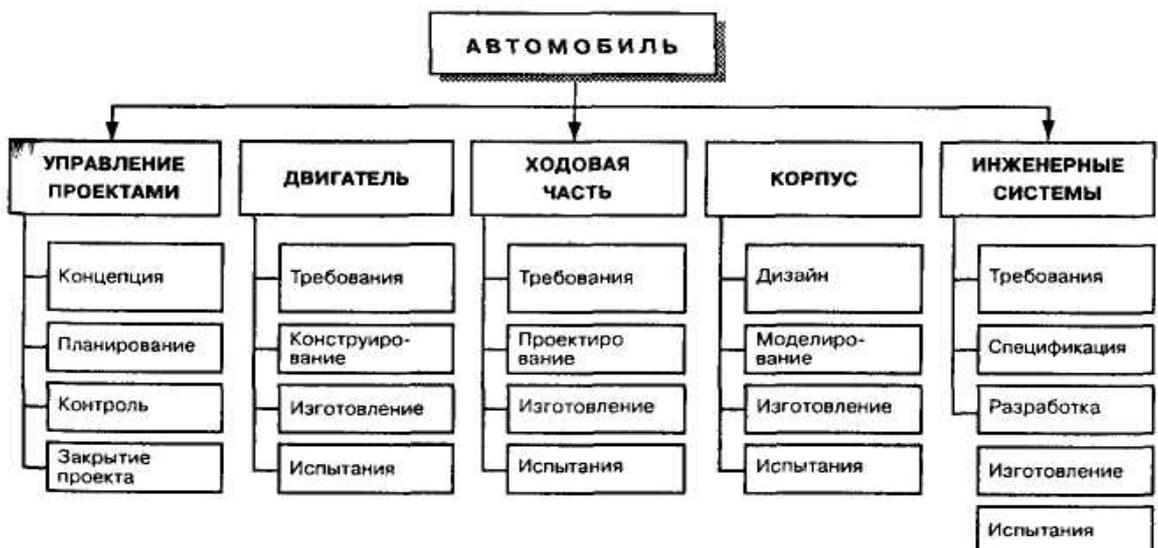
Схема 26. Пример смешанной структурной декомпозиции «Создание автомобиля»
