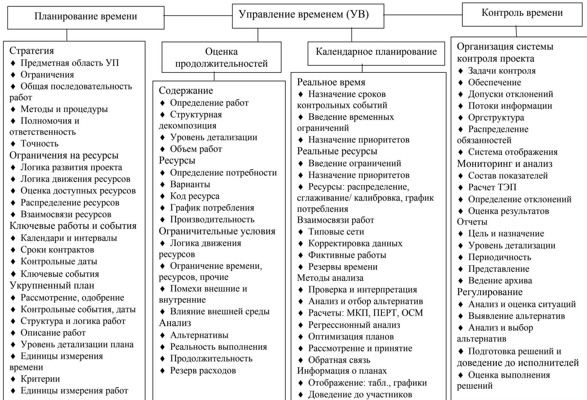
Схема 21. Принципиальная схема управления временем
