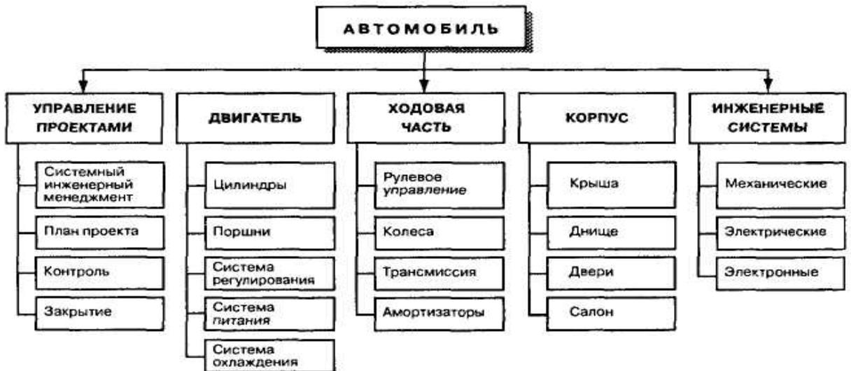
Схема 24. Пример структурной декомпозиции проекта «Создание автомобиля», ориентированной на результаты проекта
