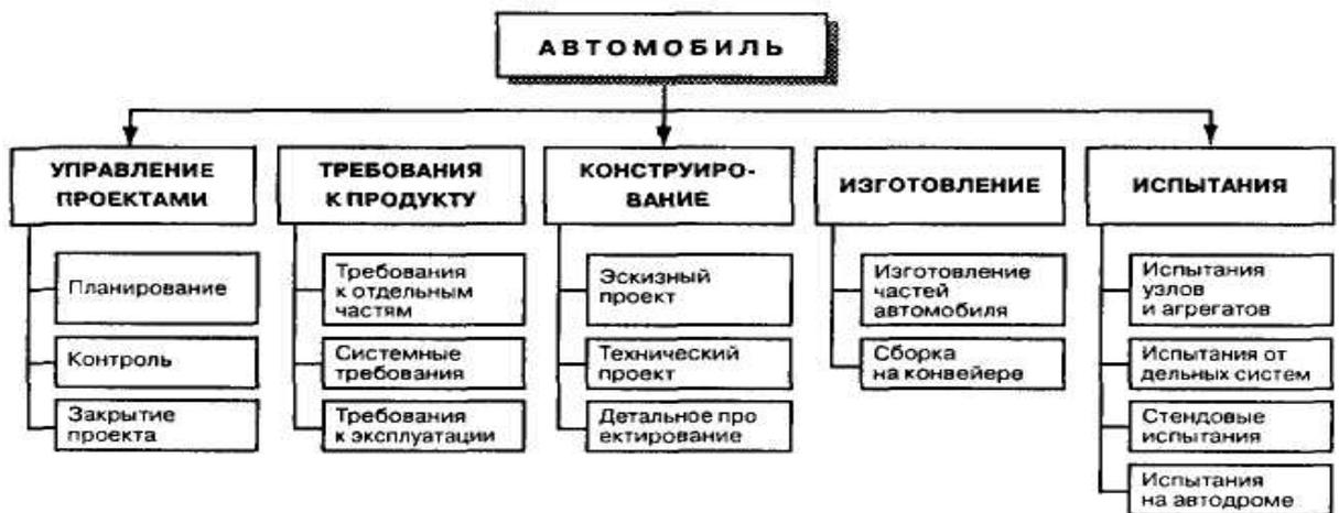
Схема 25. Пример структурной декомпозиции проекта «Создание автомобиля», ориентированной на фазы жизненного цикла проекта
