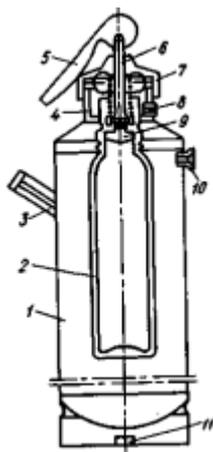
1 - корпус; 2 - кислотный стакан; 3 - боковая ручка; 4 - горловина; 5 - рукоятка; 6 - шток; 7 - крышка; 8 - спрыск; 9 - клапан; 10 - предохранитель; 11 - нижняя ручка.
