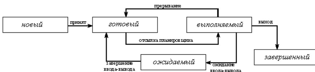
На рисунке приведена типовая диаграмма переходов для состояний процессора. В течение жизни поток переходит из одного состояния в другое в соответствии с алгоритмом планирования.
