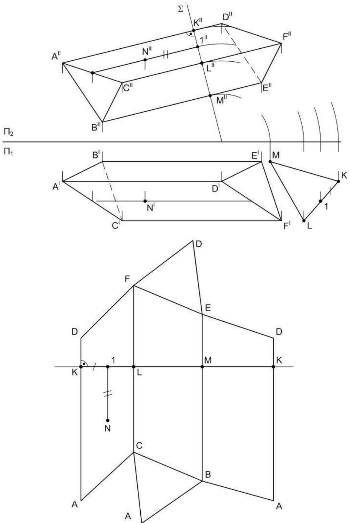
Рис. 32. Построение развертки полной поверхности призмы.
