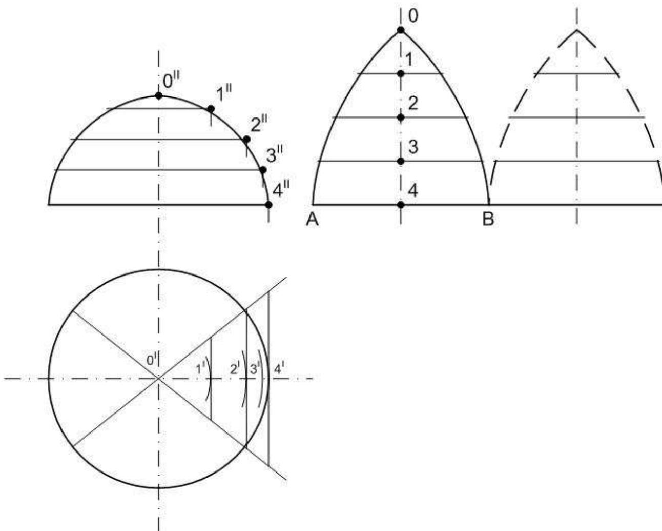
Рис. 35. Построение развертки полусферической поверхности.
