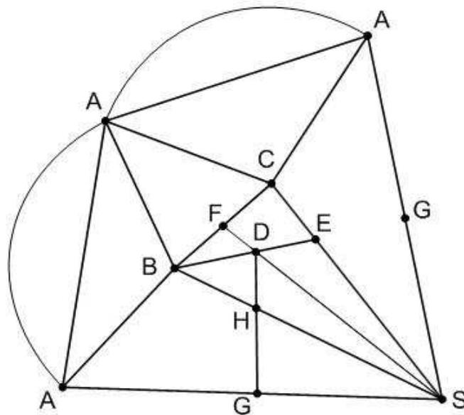
Рис. 29. Построение развёртки полной поверхности пирамиды.
