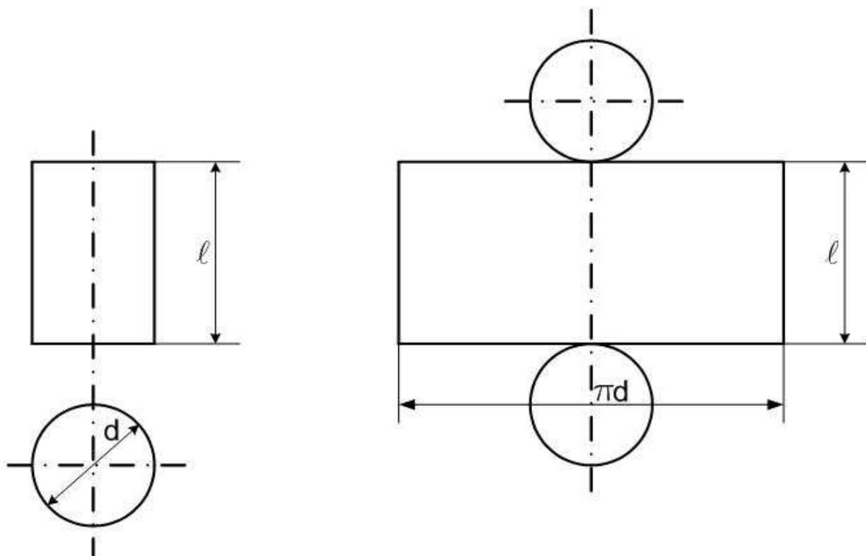
Рис. 34. Построение разверток прямого кругового цилиндра.
