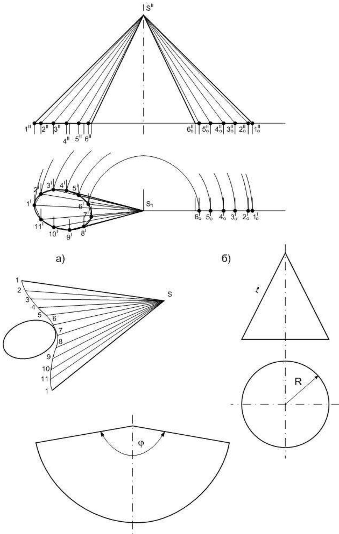
Рис. 30. Построение разверток конических поверхностей.
