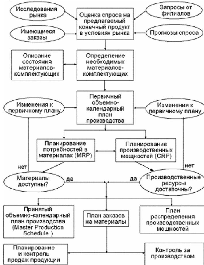
Рисунок 2 Входы и выходы MRP II-системы.
