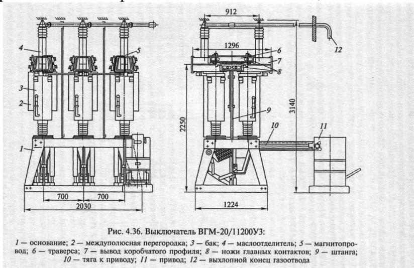
По той же конструктивной схеме (см. рис. 4.35, г) изготавливаются выключатели МГУ, рассчитанные на большие номинальные токи 6300, 11200 А, отключающую способность 90 кА, электродинамическую стойкость 300, 320 кА, термическую стойкость 90, 105 кА [1.3].
