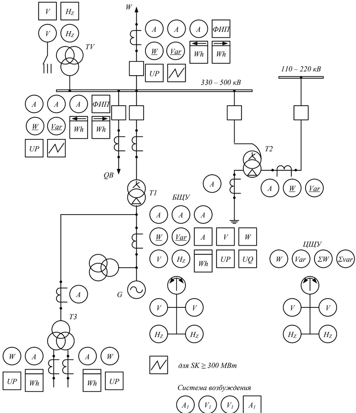
Рис. 1. Измерительные приборы в основных цепях блочной электростанции
