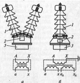
Рис. 4.61. Трансформаторы напряжения однофазные масляные:
