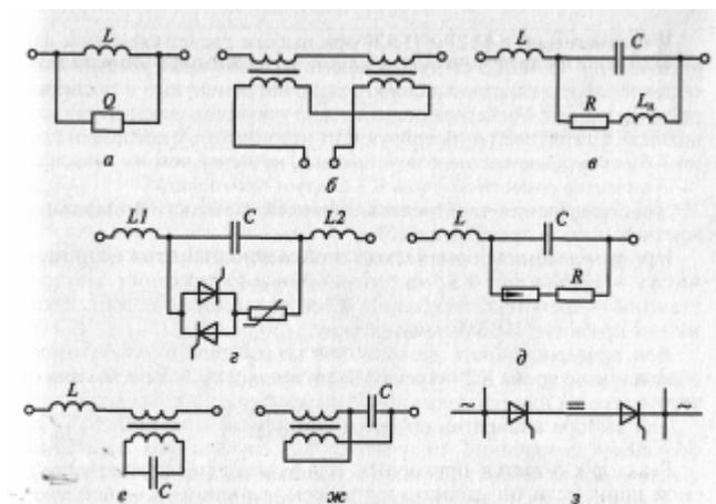
Рис. 3.21. Схемы токоограничивающих устройств:
