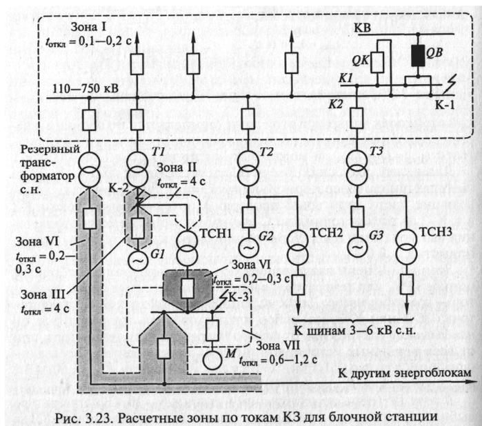
Рис. 3.23. Расчетные зоны по токам КЗ для блочной станции
