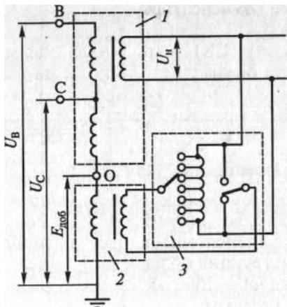
Рис. Схема включения последовательного регулировочного трансформатора в цепь автотрансформатора:
