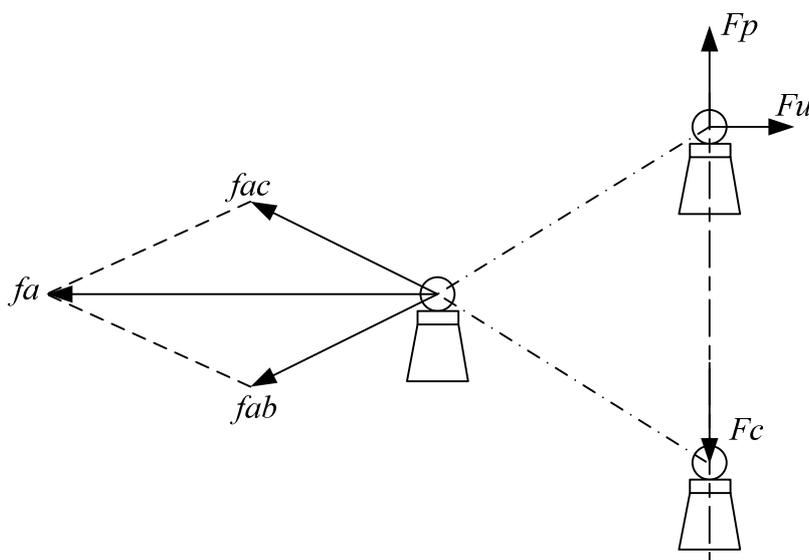
Рис. 7. К расчету шин, расположенных в вершинах треугольника
