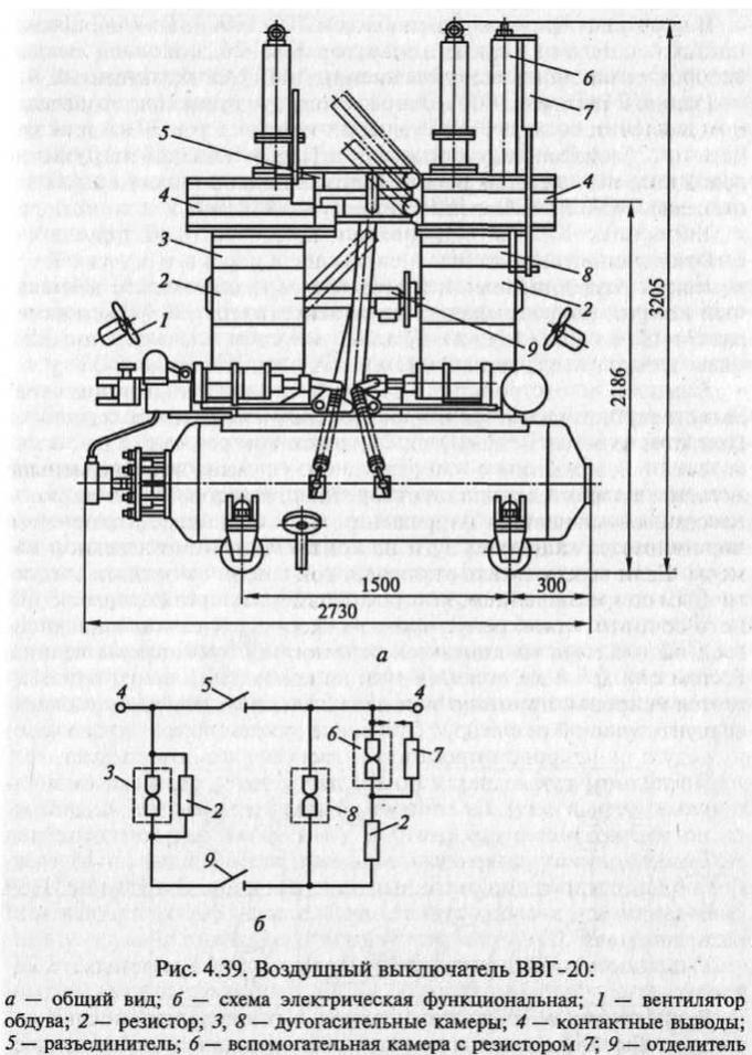
Рис. 4.39. Воздушный выключатель ВВГ-20:
