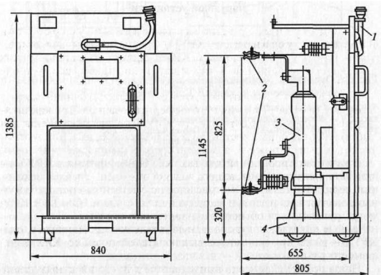
Рис. 6.6. Выкатной элемент с элегазовым выключателем VF 07 для шкафа КРУ серии К-XXVI:
