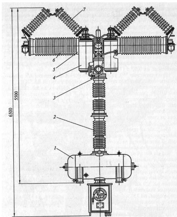
Рис. 4.42. Полюс воздушного выключателя ВНВ-220:
