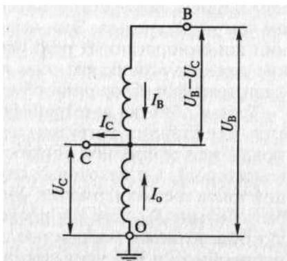
Рис. 2.20. Схема однофазного автотрансформатора
