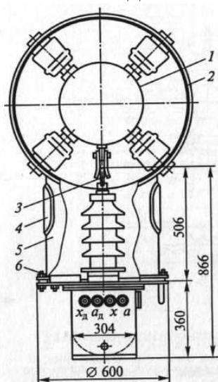
Рис. 4.62. Установка трансформатора напряжения ЗНОМ-20 в комплектном токопроводе:
