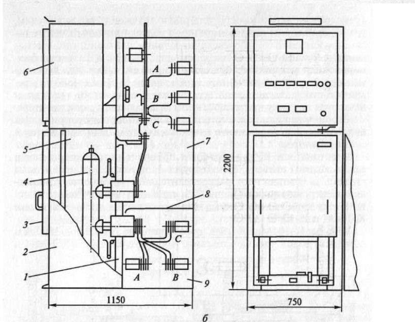
В качестве изоляции между токоведущими частями в КРУ могут быть использованы воздух, масло, пирален, твердая изоляция, инертные газы. КРУ с масляной и газовой изоляцией могут изготавливаться на высокие напряжения 220, 400 и 500 кВ. В КРУ могут применяться обычные аппараты или специально предназначенные для них, могут сочетаться и те и другие. Например, для КРУ 6—10 кВ применяются выключатели обычной конструкции, а вместо разъединителей — втычные контакты.
