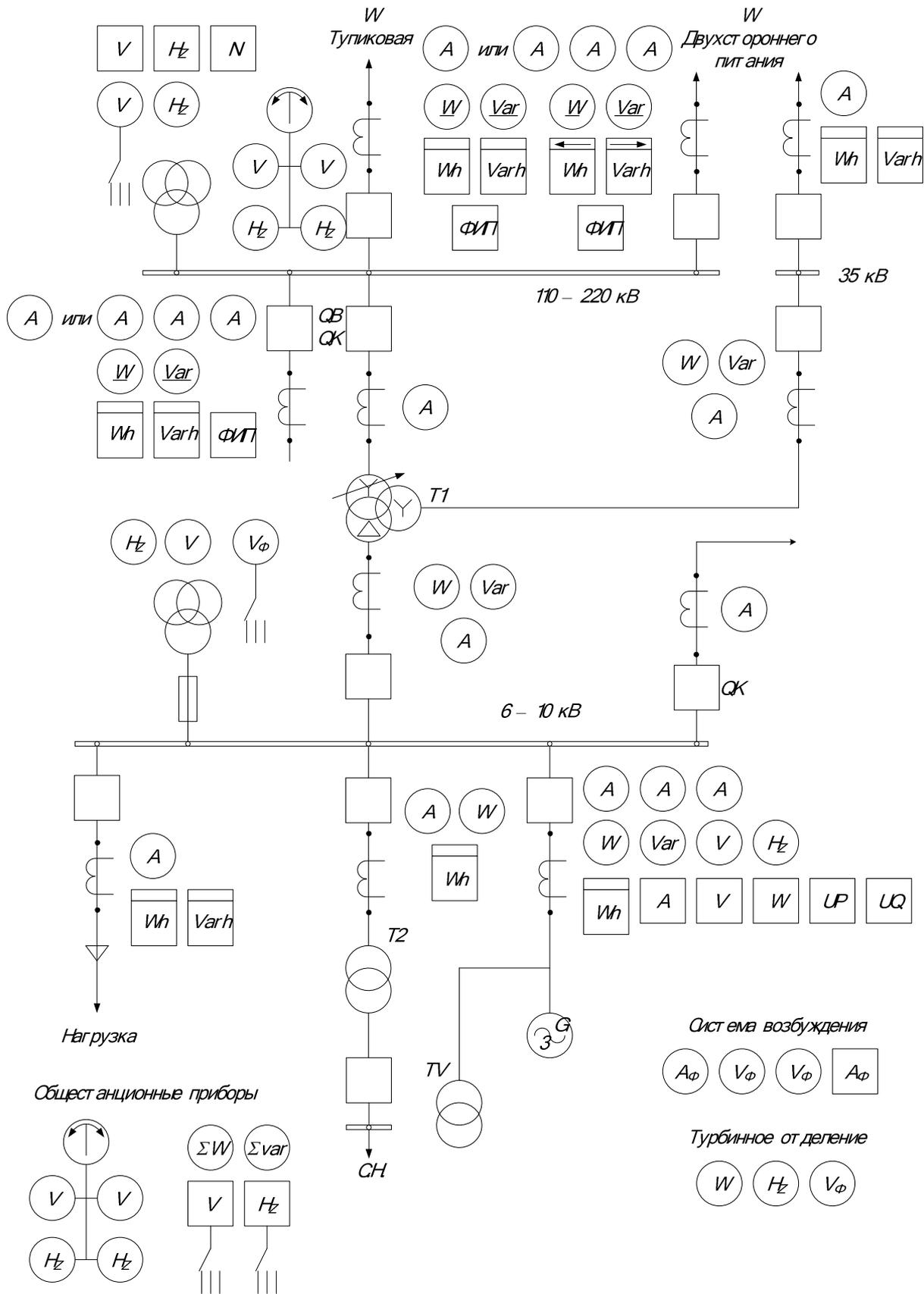
Рис. 2. Измерительные приборы в основных цепях ТЭЦ
