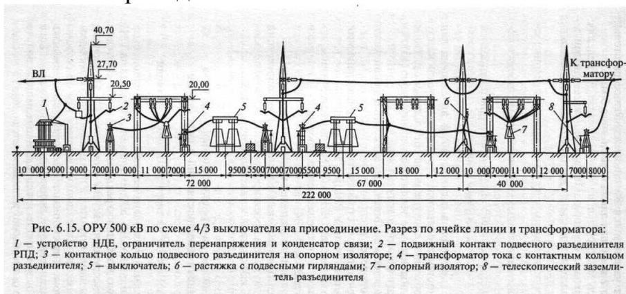
Подвижная часть подвесных разъединителей 2 подвешивается на гирляндах изоляторов к консолям и траверсам опор и порталов. Неподвижная часть монтируется на трансформаторах тока, напряжения
