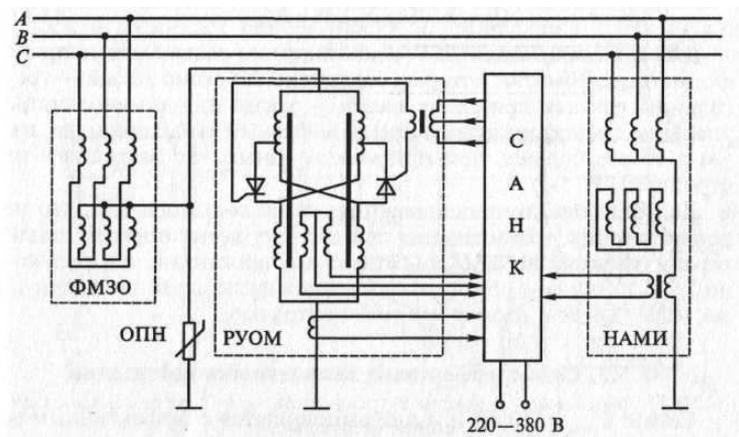
В нормальных режимах сети реактор РУОМ ненасыщен, что исключает возможность резонансных перенапряжений в нейтрали.
