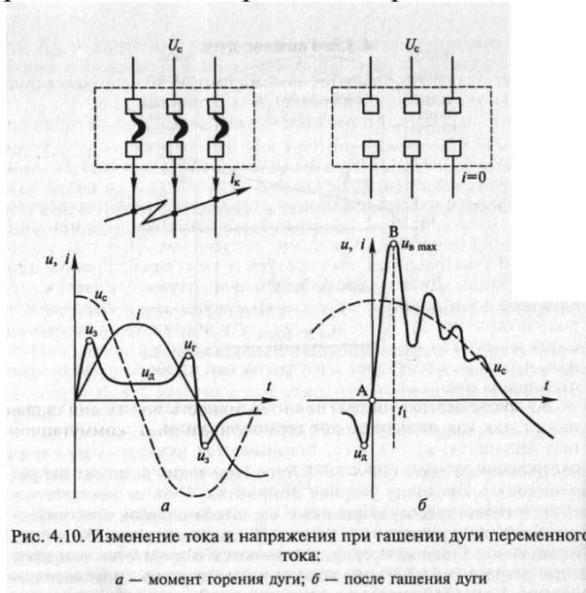
Рис. 4.10. Изменение тока и напряжения при гашении дуги переменного тока:
