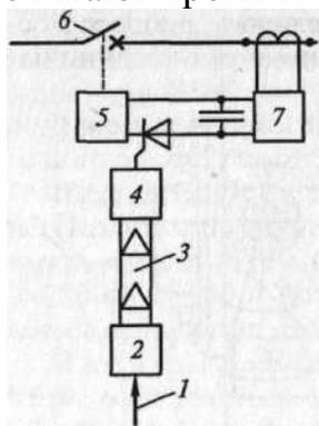
Рис. 4.51. Структурная схема управления сверхбыстродействующим выключателем: 1 — сигнал на отключение; 2 — источник световых импульсов; 3 — световод; 4 — фотодетектор; 5 — электромагнитный расцепитель; 6 — контакты выключателя; 7 — зарядное устройство
