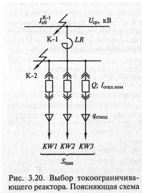
Рис. 3.20. Выбор токоограничивающего реактора. Поясняющая схема
