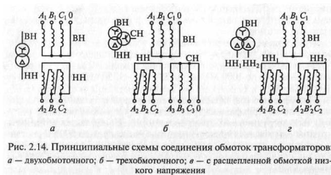
За номинальную мощность автотрансформатора принимается номинальная мощность каждой из сторон, имеющих между собой автотрансформаторную связь («проходная мощность»).
