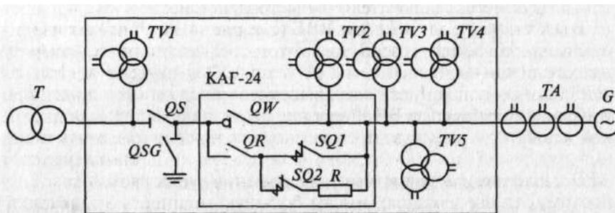
Рис. 4.40. Выключатель нагрузки генераторный КАГ-24
