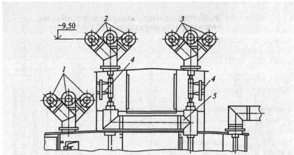
Рис. 6.3. КГРУ 6—10 кВ с двумя системами шин (второй этаж):
