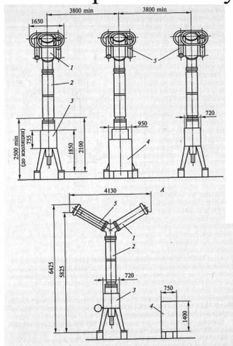
Рис. 4.48. Выключатель элегазовый ВТВ-220-45/3150:
