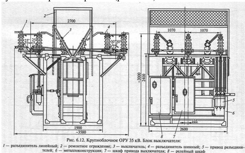
Рис. 6.12. Крупноблочное ОРУ 35 кВ. Блок выключателя:
