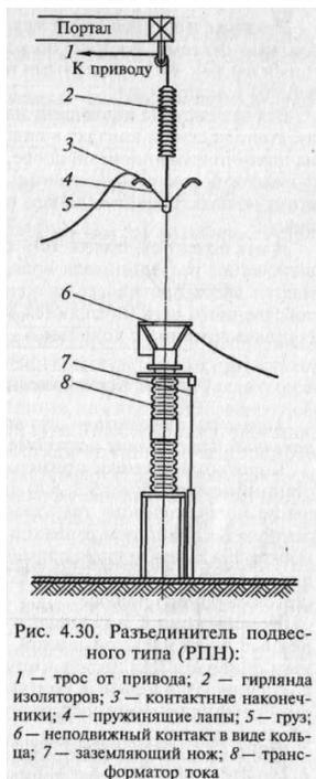
Рис. 4.30. Разъединитель подвесного типа (РПН):
