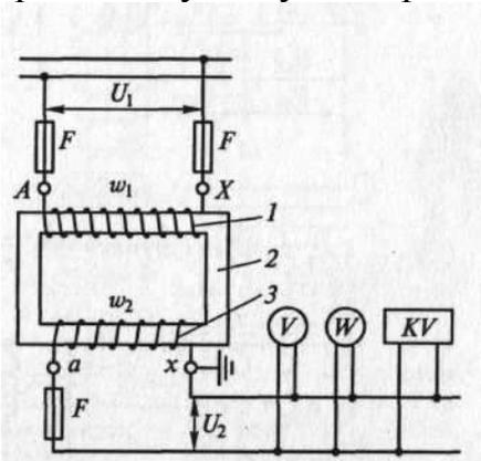
Рис. 4.59. Схема включения трансформатора напряжения:
