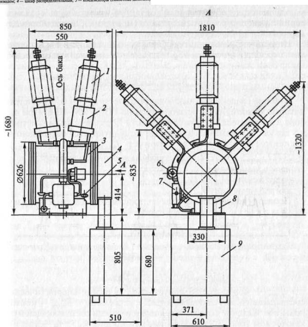
Рис. 4.49. Выключатель элегазовый баковый ВГБЭ-35:
