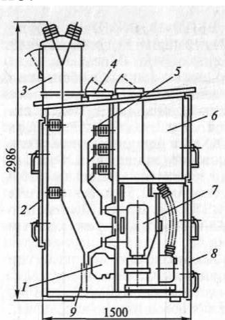
Рис. 6.7. Шкаф воздушного ввода КРУН типа КРЗ-10:
