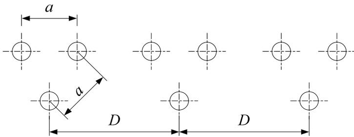
Рис. 10. Расположение расщепленных проводов
