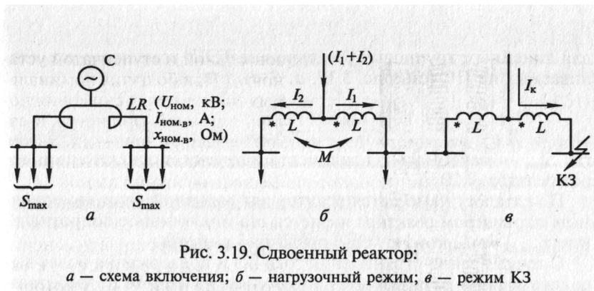
Рис. 3.19. Сдвоенный реактор:
