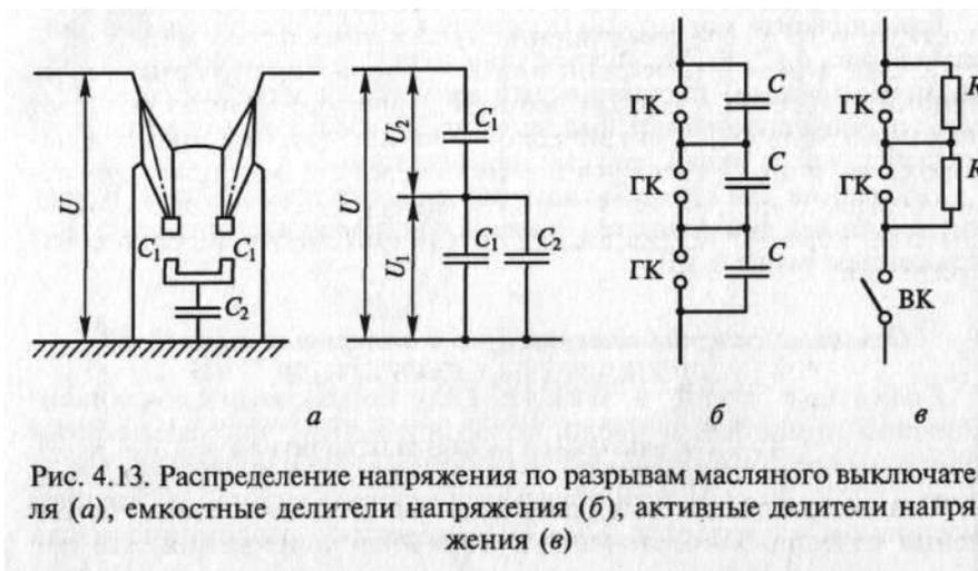
При отключении однофазного КЗ восстанавливающееся напряжение распределится между разрывами следующим образом:
