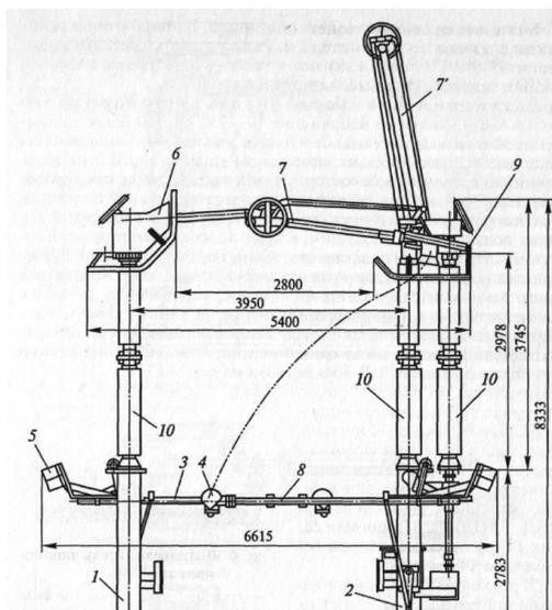
Рис. 4.29. Разъединитель полупантографный РПГ.2-330/3150УХЛ1:
