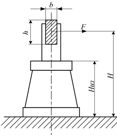
Рис. .8. К определению расчетной нагрузки на изолятор
