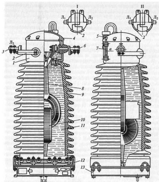
Рис. 4.57. Трансформатор тока ТФЭМ:
