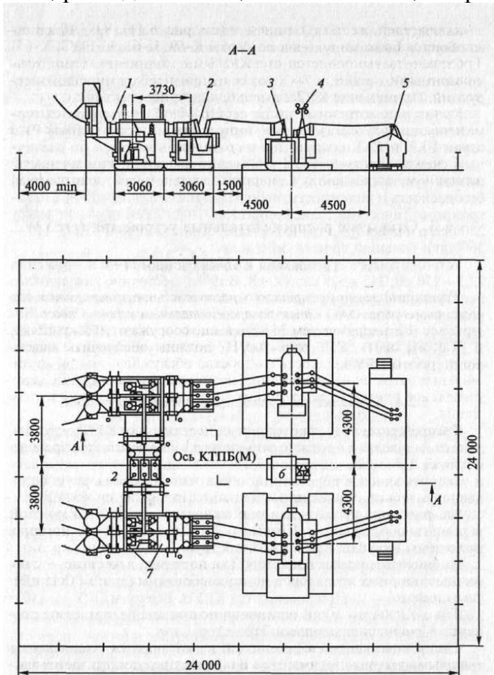
Рис. 6.11. Комплектная трансформаторная подстанция 35/10 кВ с двумя трансформаторами:
