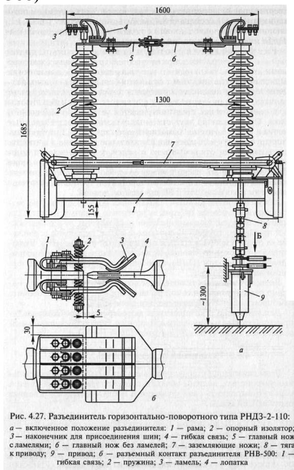
Рис. 4.27. Разъединитель горизонтально-поворотного типа РНДЗ-2-110:
