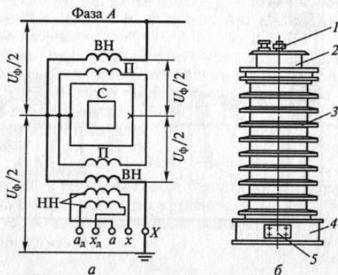
Рис. 4.63. Трансформатор напряжения НКФ-110:
