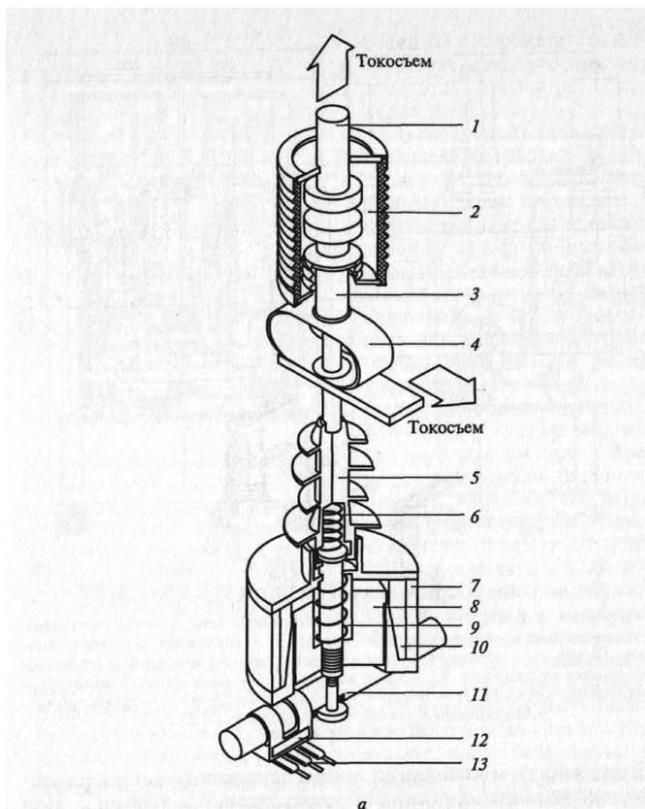
Рис. 4.46. Вакуумный выключатель ВВ-TEL-10-1000:
