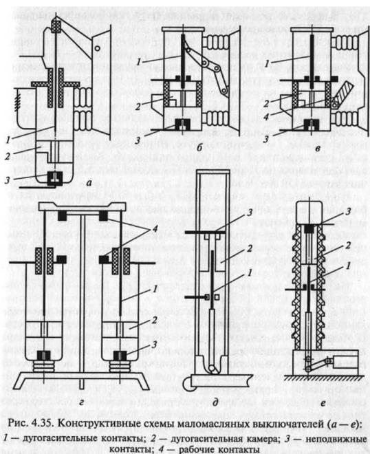
Специально для КРУ выдвижного исполнения разработаны и изготавливаются колонковые маломаляные выключатели серии ВК по схеме рис. 4.35, д.
