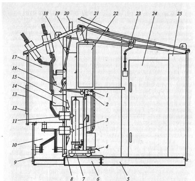
Рис. 6.8. Шкаф воздушного ввода КРУН типа К-59:
