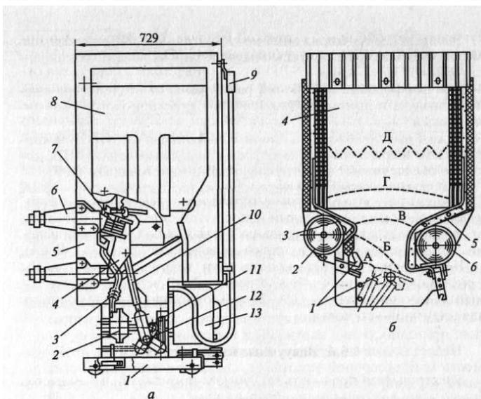
Рис. 4.43. Выключатель электромагнитный ВЭ-10-40:
