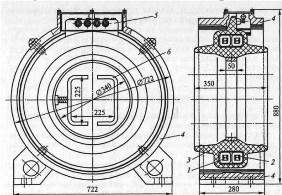
Рис. 4.56. Трансформатор тока ТШЛ-20:
