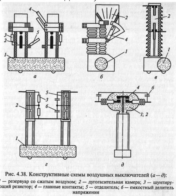
Рис. 4.38. Конструктивные схемы воздушных выключателей (а—д):
