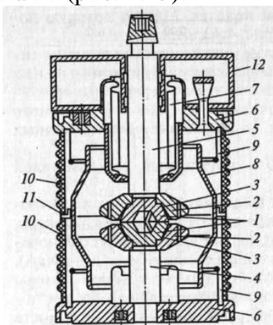
Рис. 4.44. Вакуумная дугогасительная камера КДВ-10-1600-20:
