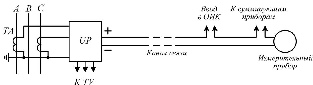
Рис..3. Структурная схема телеизмерительного устройства
