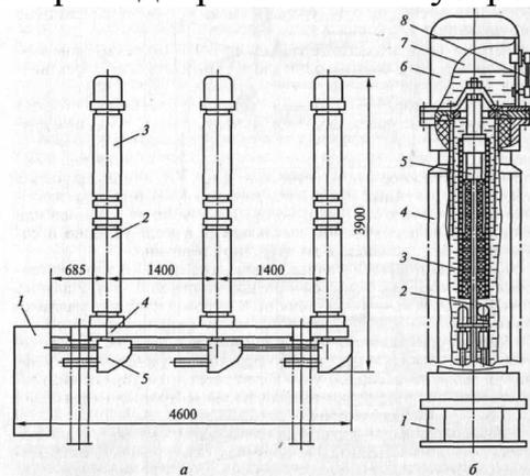
Рис. 4.37. Выключатель маломасляный ВМТ-110:
