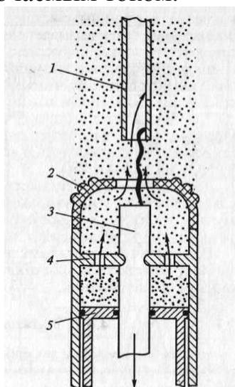
Рис. 4.47. Схема дугогасительного устройства элегазового выключателя с односторонним дутьем:
