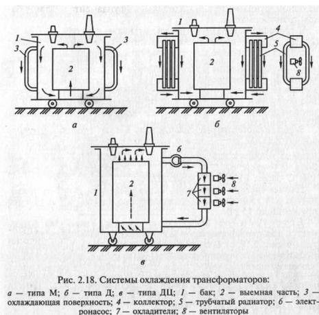
Форсированный обдув радиаторных труб улучшает условия охлаждения масла, а следовательно, обмоток и магнитопровода трансформатора, что позволяет изготавливать такие трансформаторы мощностью до 80000 кВ-А.
