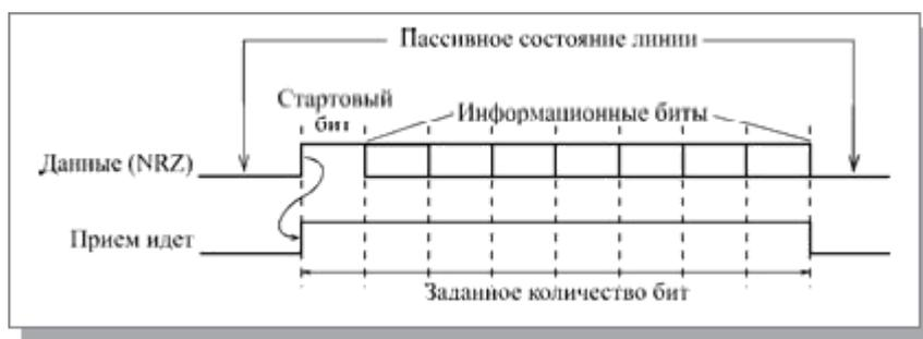
**Рис. 3.11.** Определение окончания последовательности при коде NRZ
