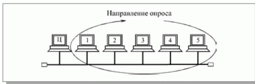
**Рис. 4.9.** Централизованное управление в сети с топологией шина
