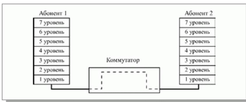
**Рис. 5.10.** Функции коммутаторов в модели OSI
