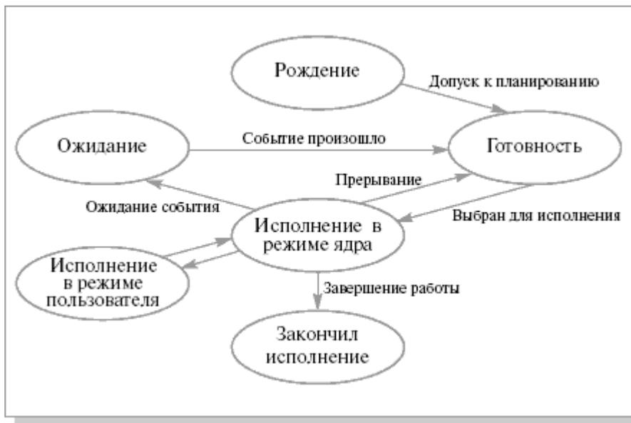
Рис. 2.2. Сокращенная диаграмма состояний процесса в UNIX
