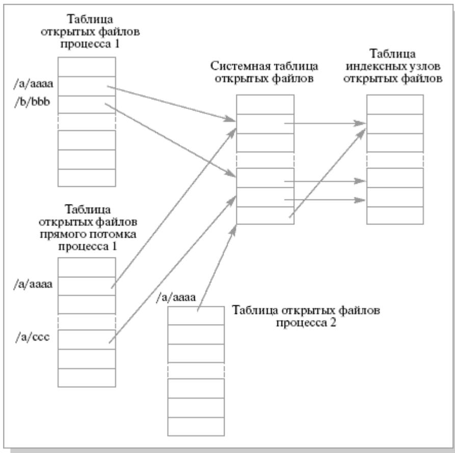
**Рис. 7.2.** Взаимосвязи между таблицами, содержащими данные об открытых файлах в системе
