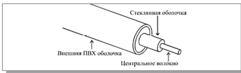
Рис. 2.4. Структура оптоволоконного кабеля
