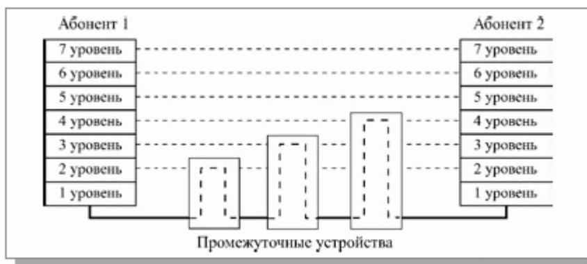
**Рис. 5.3.** Включение промежуточных устройств между абонентами сети
