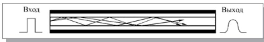
**Рис. 2.6.** Распространение света в многомодовом кабеле
