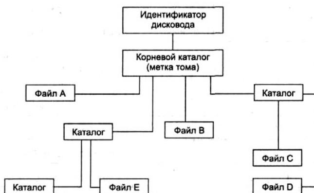
Рис. 4.8. Структура системы файлов
