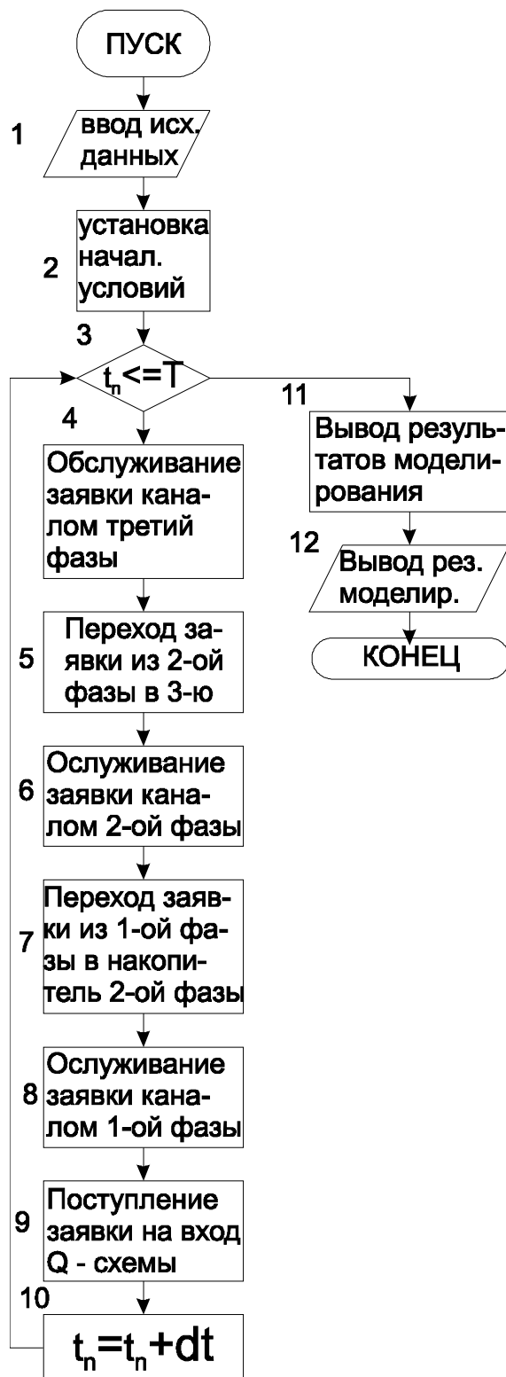
Рис. 8.5. Блок схема моделирования Q-схемы по принципу " \Delta t ". А далее более подробно рассмотрены алгоритмы блоков 4-9.
