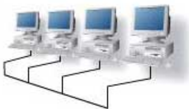
Рис. 20. Топология «общая шина»
