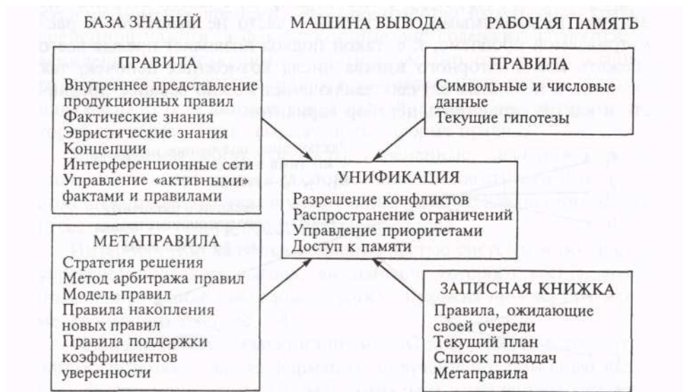
Рисунок 8.4 – Общая схема современной продукционной ЭС
