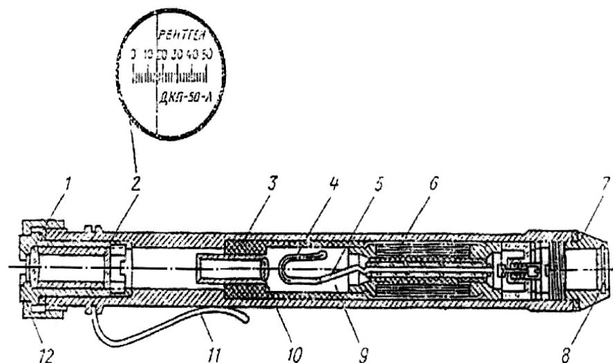
Рис.12. Дозиметр ДКП-50-А
