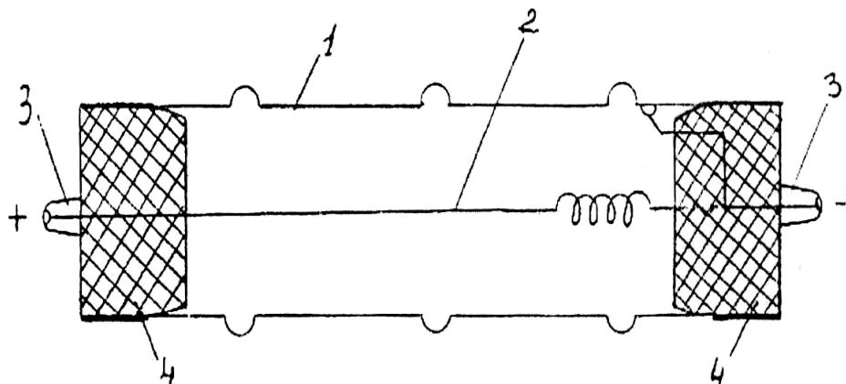
Рис. 8. Газоразрядный счетчик.
