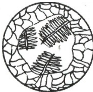
Рис. 1.4. Схема кристаллизации хлористого аммония
