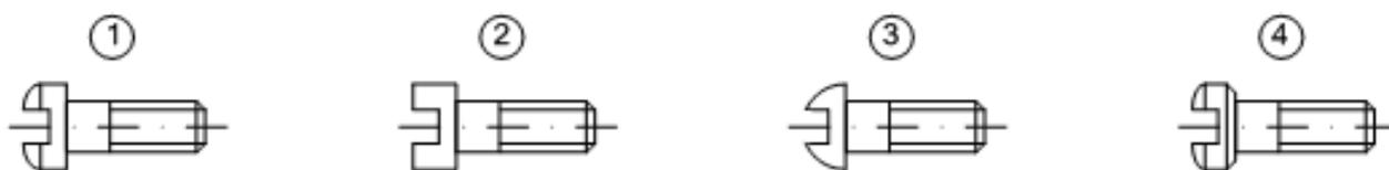
3. Соединение пайкой показано на чертеже:
