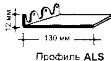
Рис. 39. Профили для создания объемных знаков
