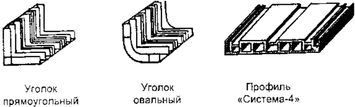
Рис. 37. Пластиковые профили для световых коробов
