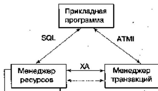
Рис. 6.5. Модель обработки транзакций X/Open DTP вида. Прикладная программа взаимодействует с RM с помощью набора специальных функций либо посредством операторов SQL (когда сервером является сервер БД).
