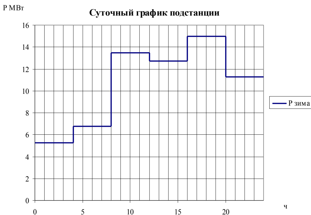
Рис. 88. Суточный график подстанции
