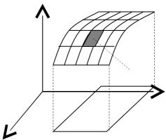
Рассмотрим произведение значения некоторой функции F в произвольной точке с координатами ( $\alpha$ ,  $\beta$ ,  $\gamma$ ) на площадь частичного участка  $\Delta S_i$ , содержащего эту точку.  $F(\alpha,\beta,\gamma)\Delta S_i$
