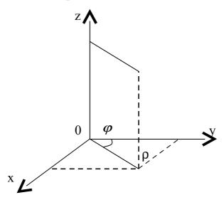
Связь координат произвольной точки Р пространства в цилиндрической системе с координатами в декартовой прямоугольной системе осуществляется по формулам:
