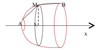
Определение: Площадью поверхности вращения кривой AB вокруг данной оси называют предел, к которому стремятся площади поверхностей вращения ломаных, вписанных в кривую AB, при стремлении к нулю наибольших из длин звеньев этих ломаных.
