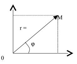
Можно установить связь между полярной системой координат и декартовой прямоугольной системой, если поместить начало декартовой прямоугольной системы в полюс, а полярную ось направить вдоль положительного направления оси Ох.
