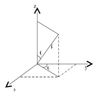
Связь координат произвольной точки Р пространства в сферической системе с координатами в декартовой прямоугольной системе
