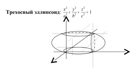
В сечении эллипсоида плоскостями, параллельными координатным плоскостям, получаются эллипсы с различными осями.
