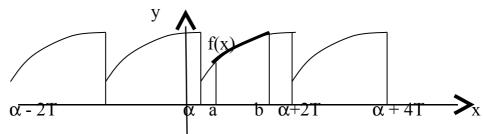
Таким образом, функция f(x) была дополнена. Теперь функция  $f_1(x)$  разлагается в ряд Фурье. Сумма этого ряда во всех точках отрезка [a, b] совпадает с функцией f(x), т.е. можно считать, что функция f(x) разложена в ряд Фурье на отрезке [a, b].
