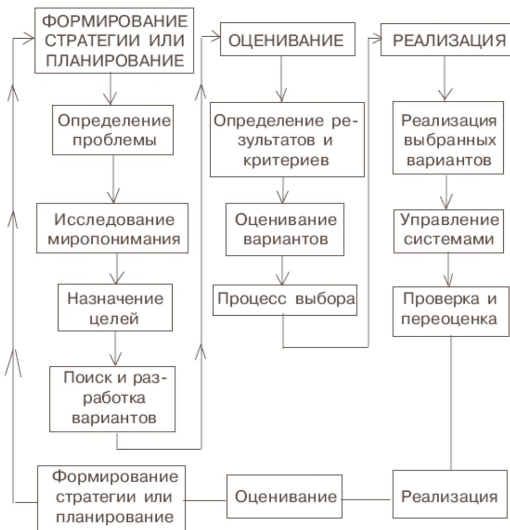
Рисунок 3.1. Цикл процесса проектирования систем.
