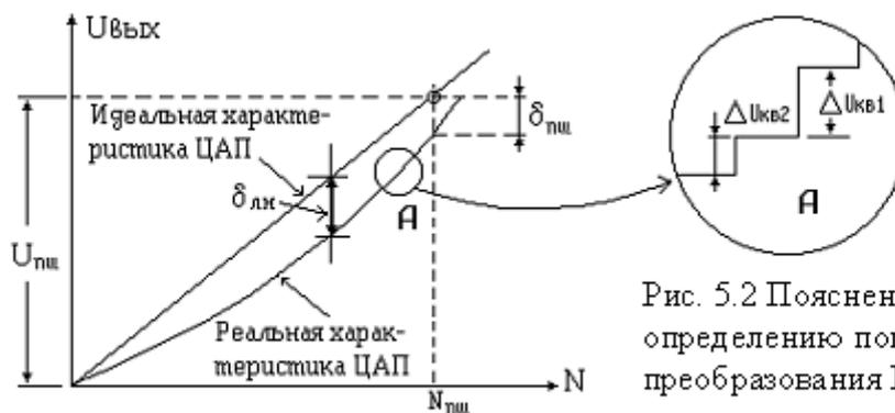
Рис. 5.2 Пояснения к определению погрешностей преобразования ЦАП
