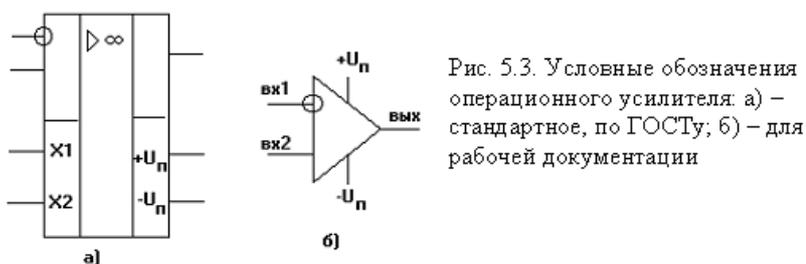
Благодаря большому коэффициенту усиления (современные ОУ имеют коэффициент усиления  $K=10^5 \dots 10^6$ ) и малым входным токам, усилители, построенные на базе ОУ, обладают уникальными свойствами. В частности, параметры многих устройств определяются только внешними цепями - цепями обратной связи, соединяющими выход ОУ с его входом. Например, коэффици-
