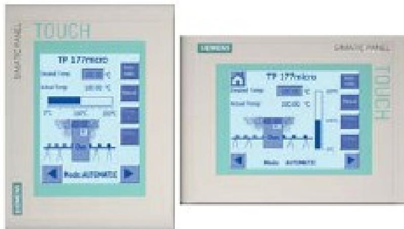
Панель оператора TP 177 Micro оснащена 5.7' графическим дисплеем голубого свечения с разрешением 320x240 точек или 240x320 точек и сенсорной резистивной аналоговой клавиатурой. Подключение к S7-200 выполняется через PPI интерфейс центрального процессора. По основному набору функций человеко-машинного интерфейса она близка к панели OP 73 Micro, но имеет лучшие графические возможности и позволяет обслуживать до 500 сообщений и до 250 экранных изображений.
