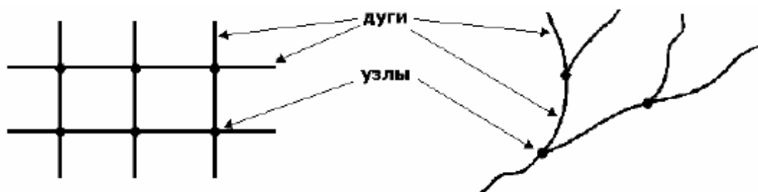
Рис.1.16. Пример слоев, составленных из дуг и узлов.
