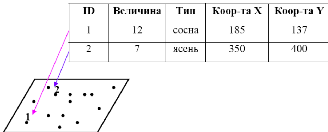
Рис.2.3. Пример формы представления объектов в виде нерегулярной сети точек.
