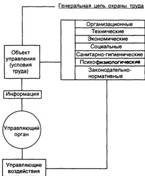
Рисунок 1 - Принципиальная схема процесса управления охраной труда
