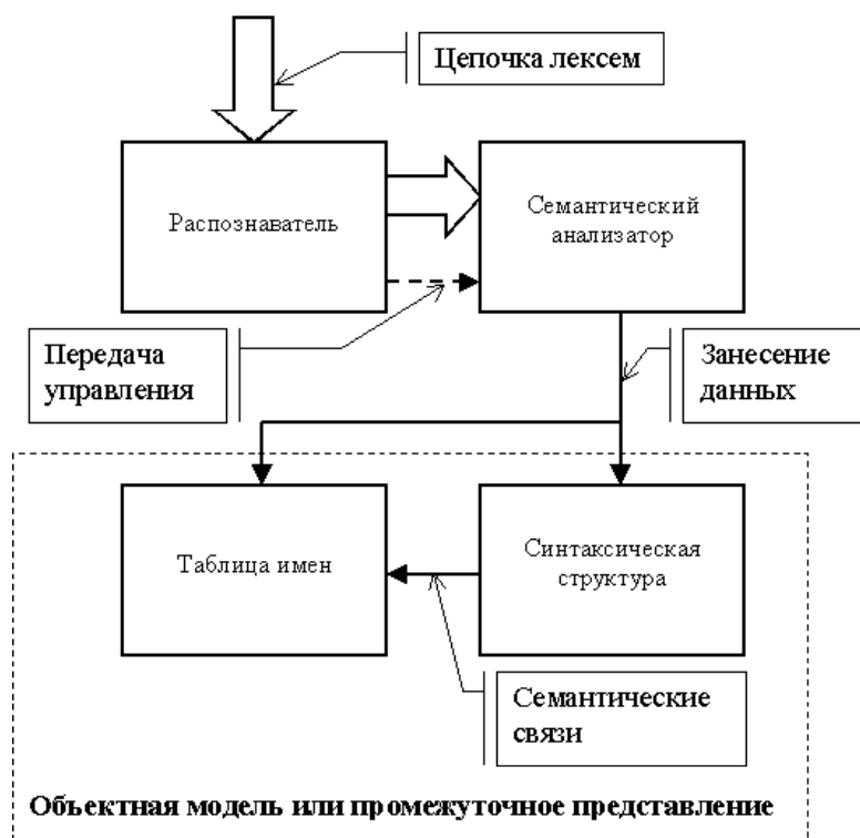
Рис. 1.6. Обобщенная схема синтаксического анализатора
