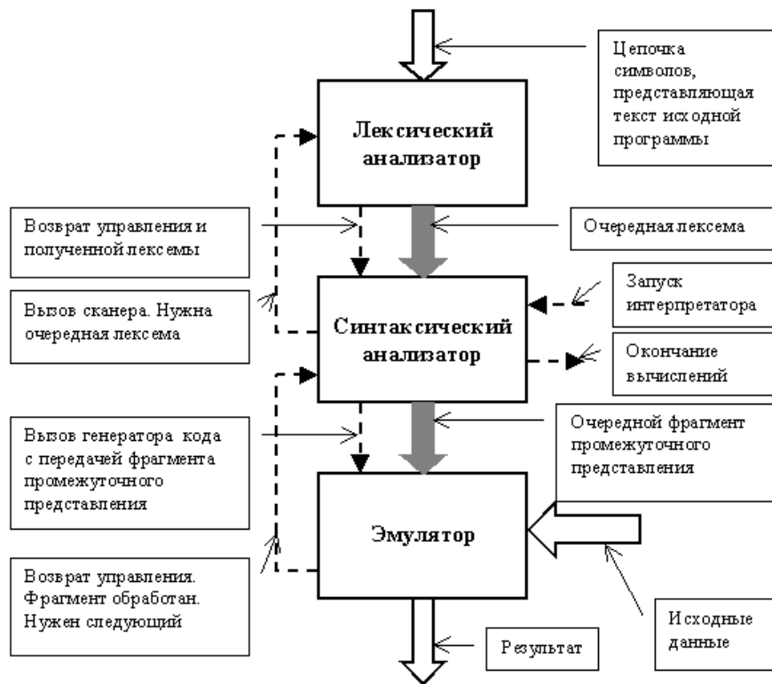
Рис. 1.10. Однопроходное взаимодействие блоков интерпретатора.
