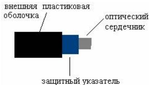
Различают одномодовый и многомодовый оптоволоконные кабели. В одномодовом кабеле более тонкий центральный сердечник, он пропускает один световой луч, который почти не отражается от внешнего отражателя. В многомодовом кабеле используется более толстый центральный сердечник, в котором одновременно существует несколько световых лучей с разными углами преломления.
