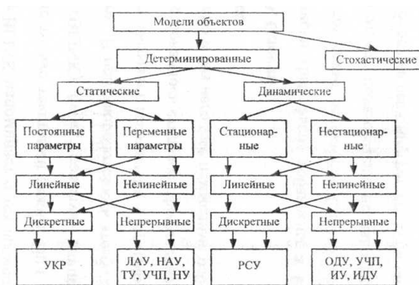
Рис. 6.1. Математические модели объектов, их классификация: Системы уравнений: УКР в конечных разностях; ЛАУ - линейные алгебраические; НАУ - нелинейные алгебраические; ТУ - трансцендентные; УЧП - в частных производных; РСУ - разностные; ОДУ - обыкновенные дифференциальные; НУ - интегральные; ИДУ - интегро-дифференциальные.
