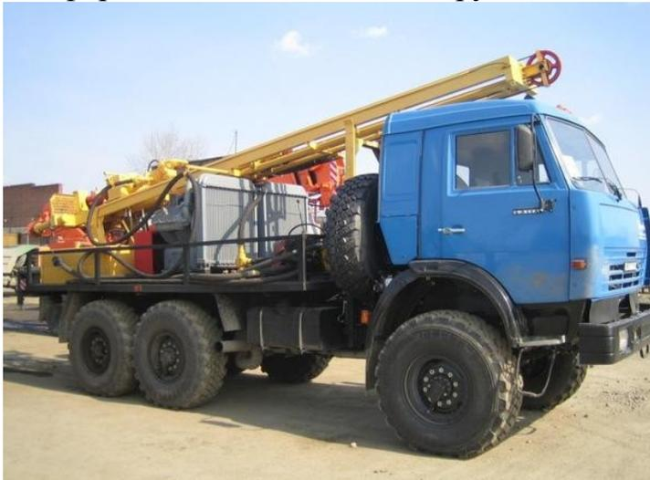
рошую подвижность и обеспечивает проходимость в труднодоступных районах работ (*рис. 12*). Такие установки называются *самоходными бурильными установками*.
