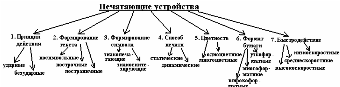
Рис. 19.1. Классификация печатающих устройств
