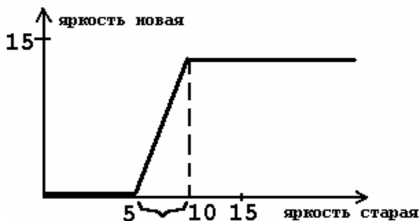
Рис. 18.3. Простейшая функция преобразования уровня яркости
