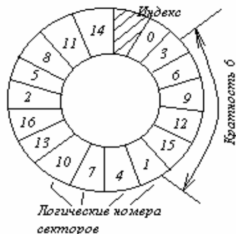
Рис. 14.4. Расположение секторов в НЖМД
