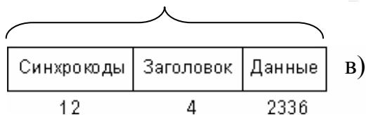
Рис. 15.2. Формат данных для CD-ROM: общий (а); при записи в режиме CD-ROM-1 (б) и в режиме CD-ROM-2 (в)
