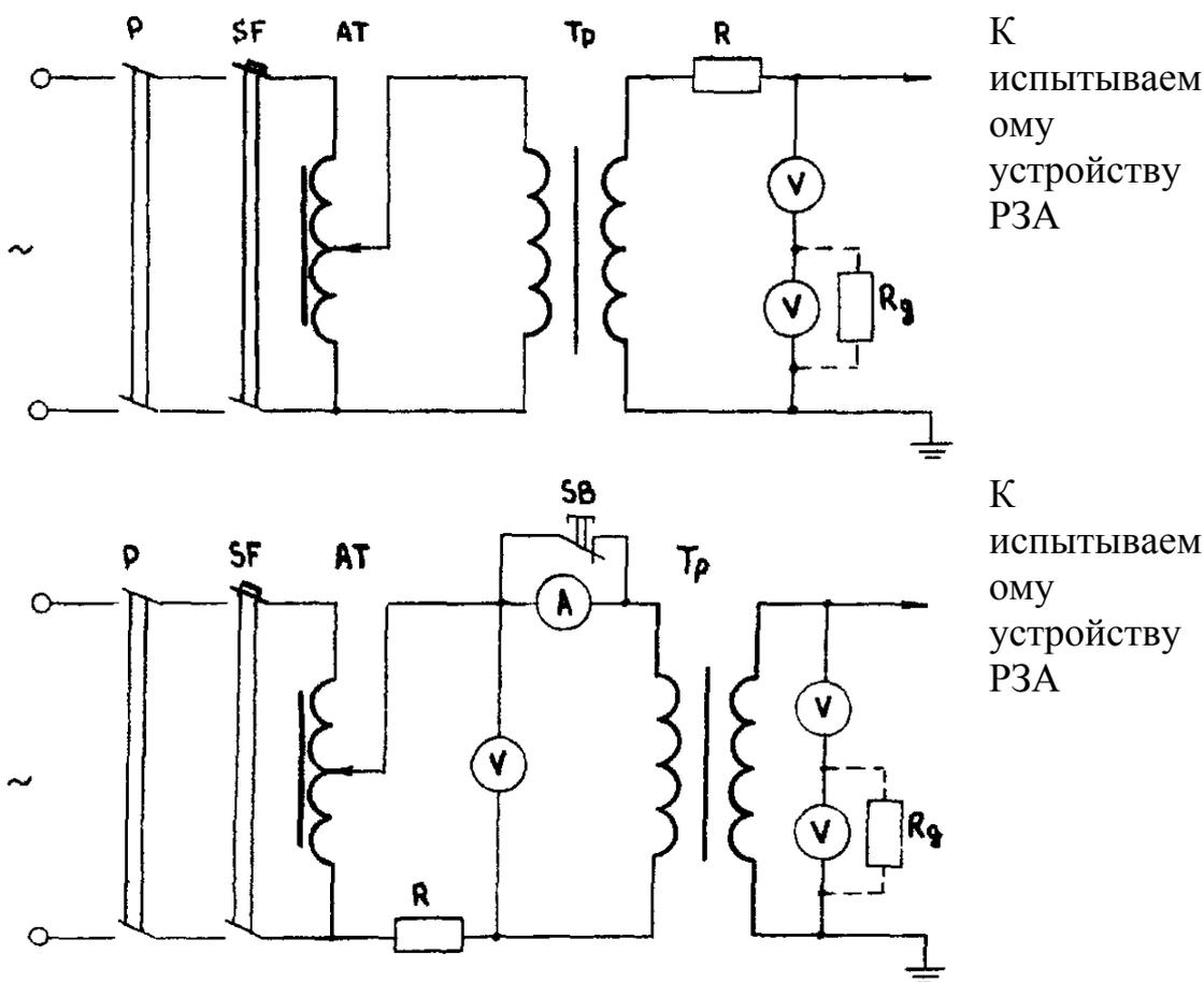
Рис.4. Схема испытания электрической прочности изоляции:
