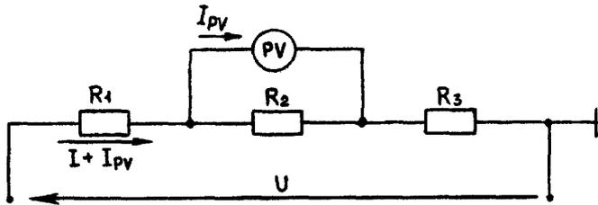
Рис.2. Изменение токов при подключении в схему вольтметра с недостаточно большим внутренним сопротивлением
