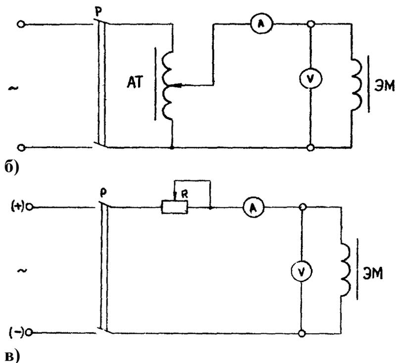
Рис.5. Схемы для проверки электрических характеристик электромагнитов приводов коммутационных аппаратов с помощью:
