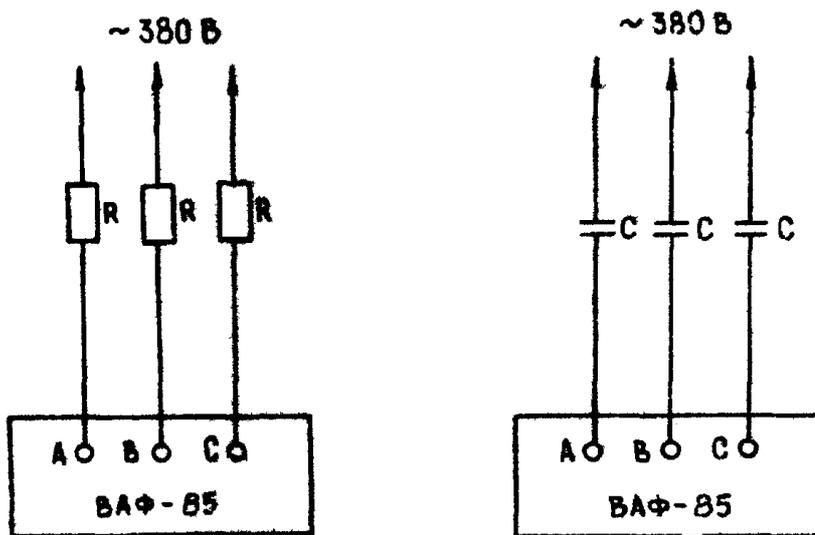
Рис.14. Схемы подключения прибора ВАФ-85 к сети 380В через дополнительные:
