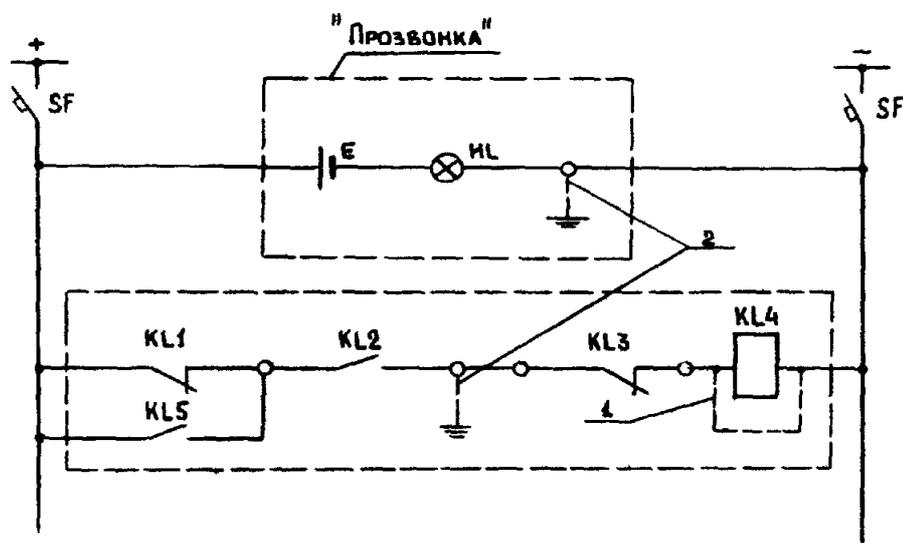
Рис.9. Отыскание неисправности в схеме с помощью "прозвонки"
