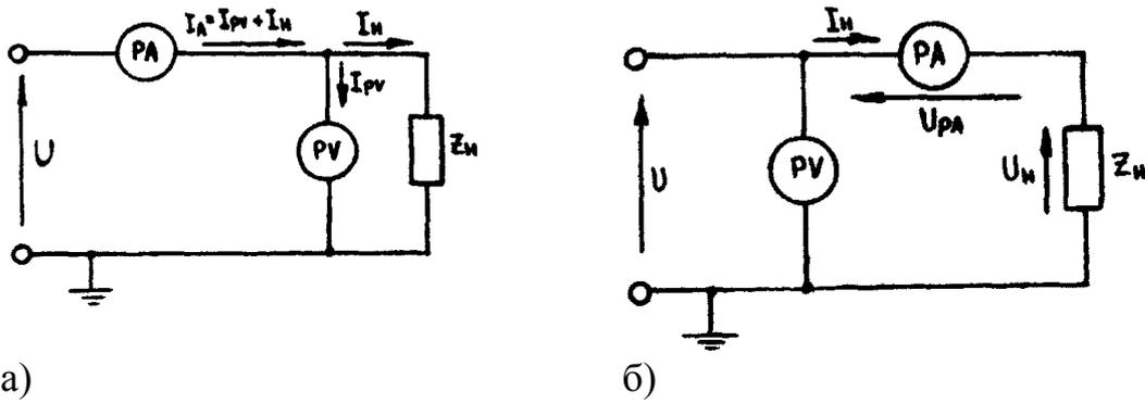
Рис.1. Схемы включения амперметра и вольтметра для снятия вольтамперных характеристик: а - для  $Z_H \ll R_{PV}$ , б - для  $Z_H \gg R_{PA}$
