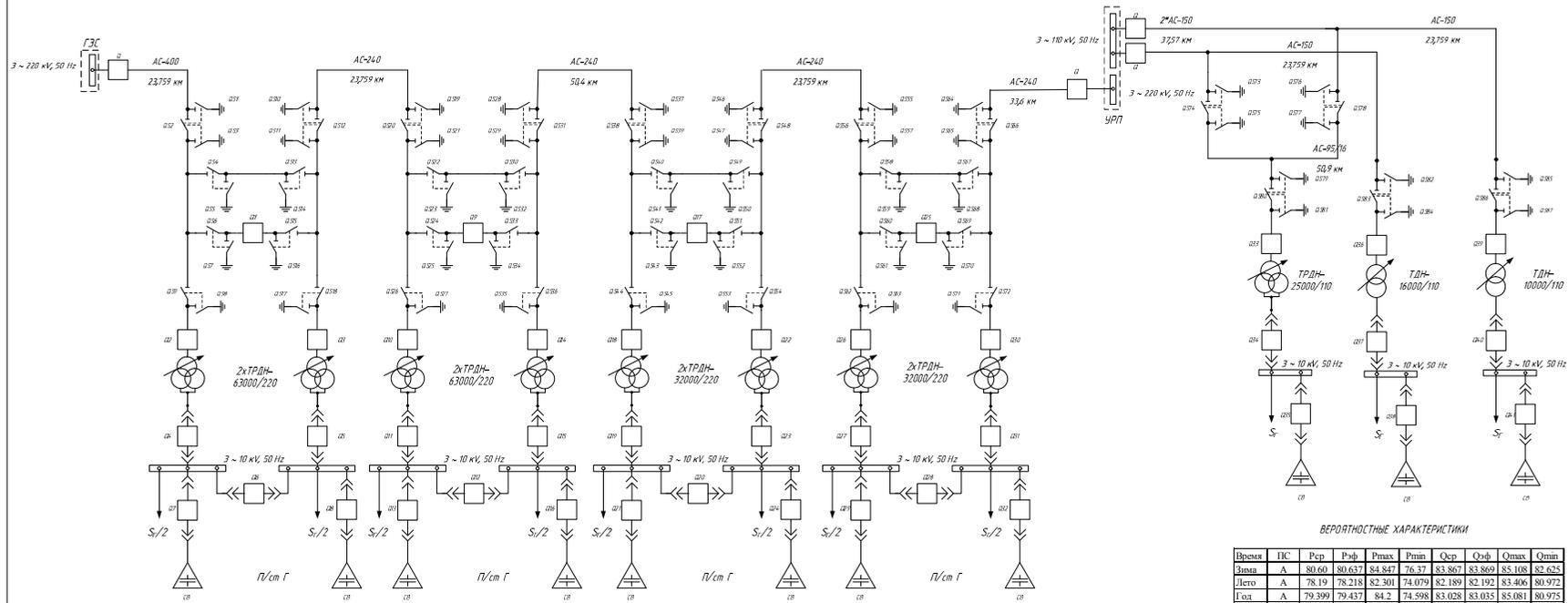
Схема замещения проектируемой электрической сети (трансформаторы показаны одной трансформаторной ветвью)
