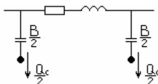
Рис. Схема замещения линии
