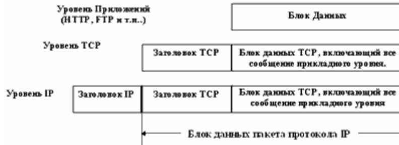
Рис. 4. Инкапсуляция протоколов верхнего уровня в протоколы TCP/IP
