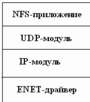
Рис. 6. Стек протоколов при работе через транспортный протокол UDP
