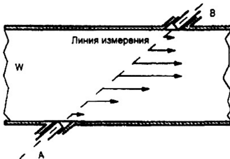
Рис. 82. Принцип действия ультразвукового расходомера
