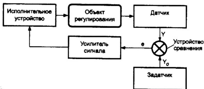
Рис. 84. Функциональная схема замкнутой системы регулирования
