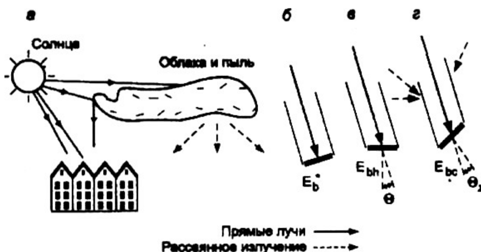
Рис. 21. Прямое и рассеянное солнечное излучение (а) и регистрация прямого потока солнечного излучения (б-г)
