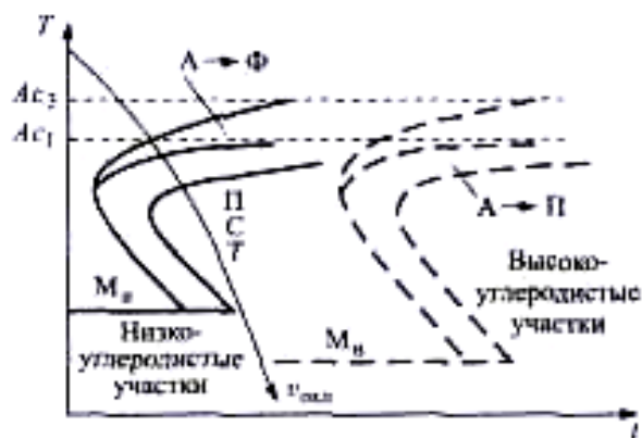
Рис. 5.7. Диаграммы распада неомогенного аустенита в доэвтектоидной стали: А-аустенит, П-перлит, Ф-феррит, Т-троостит
