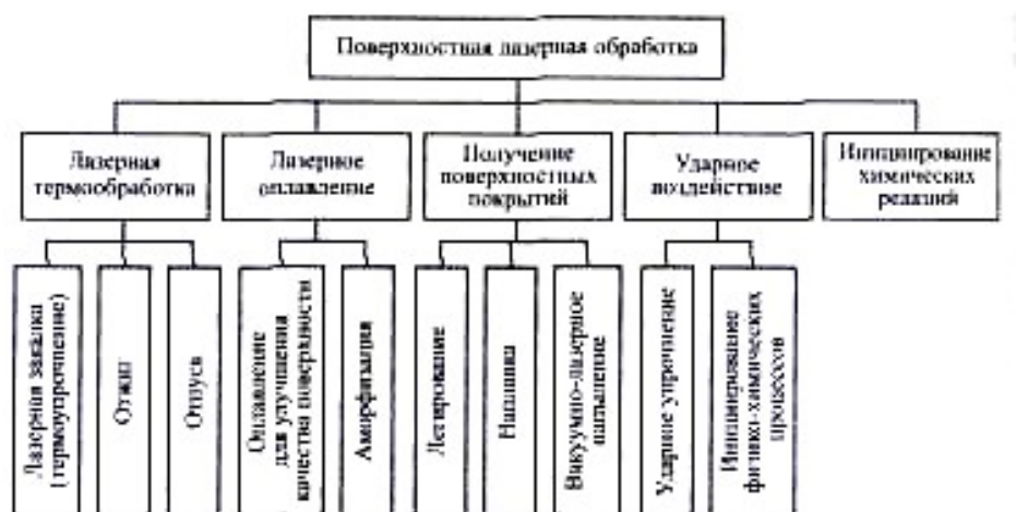
Рис. 5.1. Классификация методов поверхностной лазерной обработки по технологическим признакам
