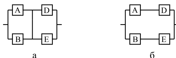
Рис.7.3. Преобразования мостиковой схемы при абсолютно надежном (а) и отказавшем (б) элементе С.
