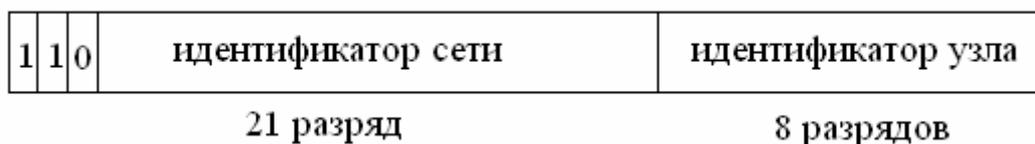
Рисунок 1. Формат IP-адреса класса С.
