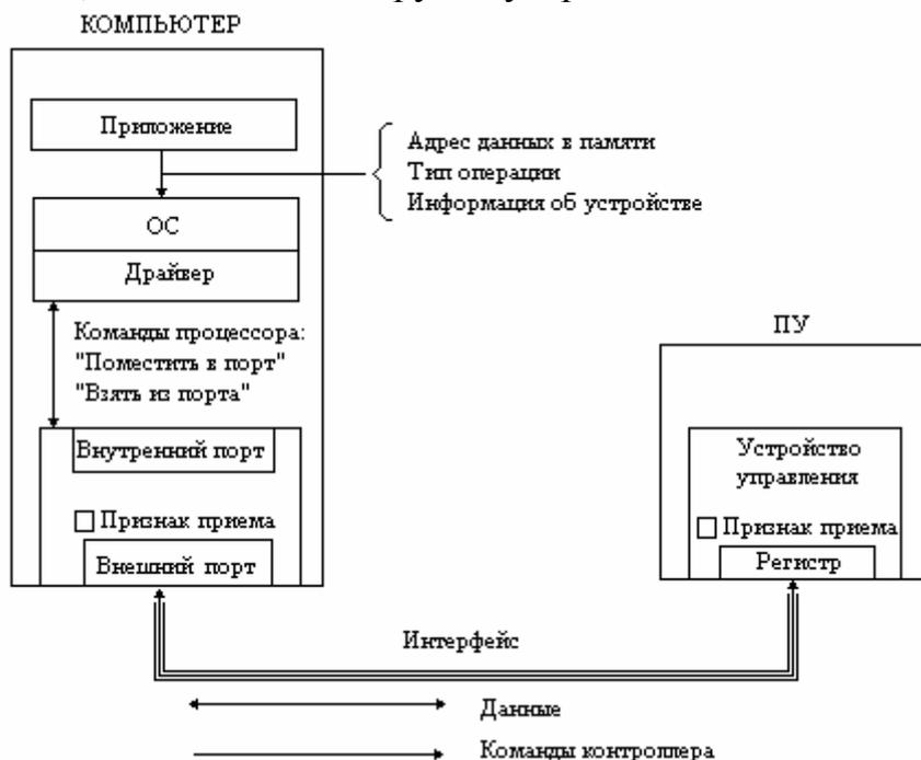
**Рис. 1.1.** Связь компьютера с периферийным устройством
