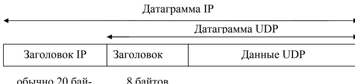
Рисунок 4. Датаграмма UDP внутри датаграммы IP
