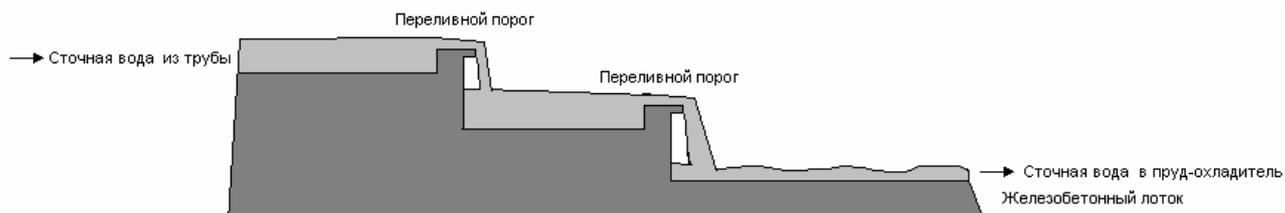
Рисунок 1 - Водосброс с переливным порогом
