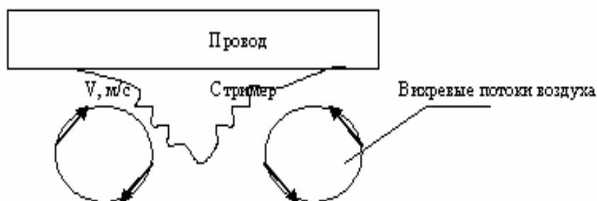
Рисунок 3 – Образование вихревых потоков в зоне стримерной короны
