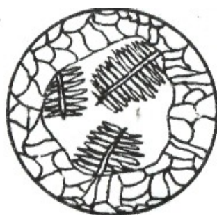
Рис. 2.4. Схема кристаллизации хлористого аммония
