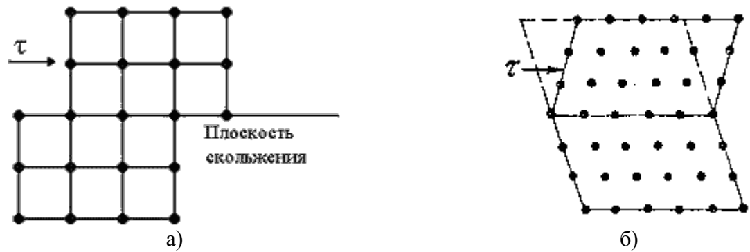
Рис.6.5. Схемы пластической деформации различными способами: а – скольжением; б – двойникованием
