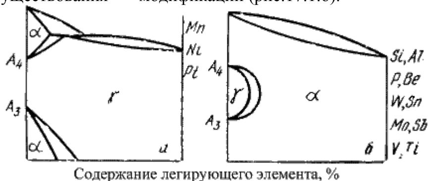
Рис. 17.1. Схематические диаграммы состояния Fe – легирующий элемент. а – для элементов, расширяющих область существования \gamma -модификации; б – для элементов, сужающих область существования \gamma -модификации
